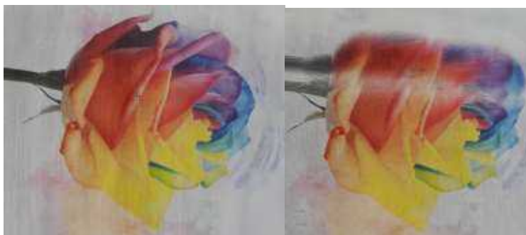
شکل ۲- بهترین نمونه‌های کیفیت چاپ تصویر بر روی کاغذهای سوپرکرافت راشا (سمت راست) و کرافت تبریز آندودشده (سمت چپ) Figure2- The Best Quality Printing Samples on the Rasha Super kraft (on the right) and Tabriz Kraft Coated papers (on the left)
